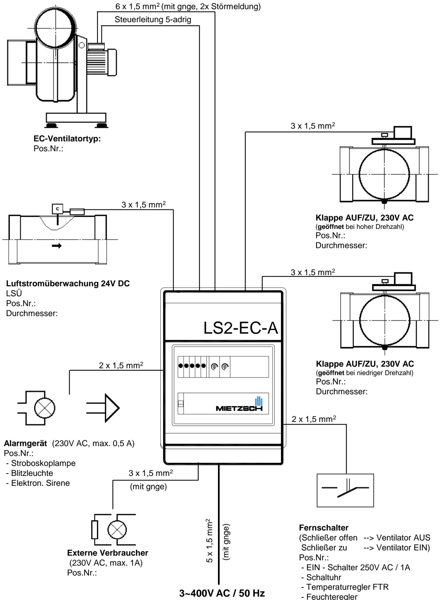
Der jeweilige Kabeltyp ist entsprechend den Einsatzbedingungen und der Verlegeart auszuwählen. Der Geräteanschluss erfolgt nach den jeweiligen Klemmplänen, die den Geräten beiliegen (insbesondere Bedienungsanleitung).
