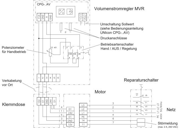
Netzanschluss: Klemmen L1, L2, L3 und PE am Reparaturschalter
