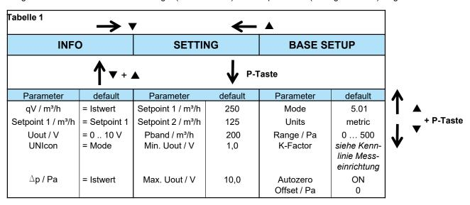
Sollte die Notwendigkeit bestehen, bei bestimmten Betriebszuständen der Anlage auf einen zweiten Sollwert umzuschalten, kann dieser mit dem Parameter Setpoint 2 im Menü SETTING eingestellt werden. Die Umschaltung erfolgt durch Anlegen einer Spannung an den Klemmen 1 und 2 des Reglers CPG-..AV ( 10..24 V DC, Polarität beachten, siehe Anschlussplan ).
