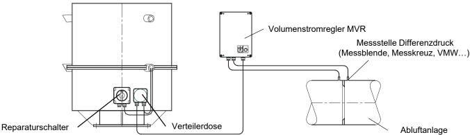
Die Ventilatoren der Baureihe VRV...-EC mit Volumenstromregler MVR wurden auf der Basis der bewährten der Baureihe VRV als Ergänzung zu den bei Kunststoff-Dachventilatoren vorwiegend verwendeten drehzahlregelbaren Antrieben in der Kombination von Asynchronmotor und Frequenzumrichter (Ausführung mit Volumenstromregelung) entwickelt. Für den Einsatz und Betrieb gelten auch alle Festlegungen und Hinweise in der Betriebsanleitung "Dachventilatoren VRV".
